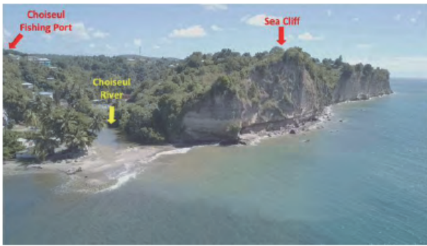
図5 ショゼール漁港の土砂供給源 (ショゼール川と漁港の南側に続く海食崖) 19)
