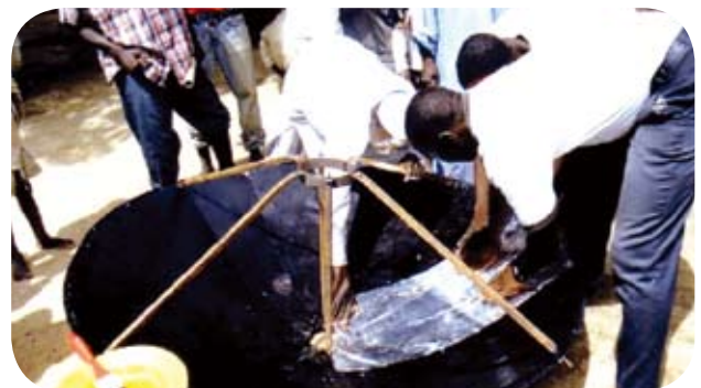
写真9 太陽熱集積装置（ソーラー・クッカー）を作製中（反射面にアルミホイルを貼り付けている様子）
